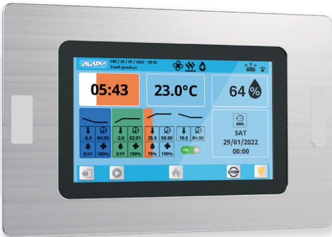
Ciclo Fermalievitazione automatico in esecuzione, con valori correnti, valori impostati e avanzamento
